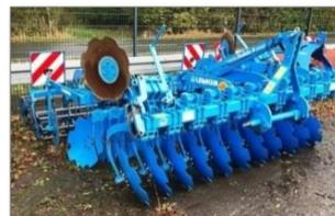
Des Weiteren stehen auf der Maschinenstation Petschl in Marbach eine **Kurzscheibenegge Lemken Rubin 9** mit einer AB von 3 m
